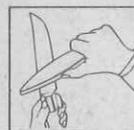
Avec une pierre à affûter sur une lame sèche et dégraissée. Passer la pierre de la base de la lame vers la pointe selon un angle de 20°.
